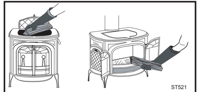
**Fig. 33** Le chargement par le haut est la meilleure façon d'ajouter du combustible dans le cas d'une utilisation régulier. Le chargement avant est utile pour allumer le feu.
