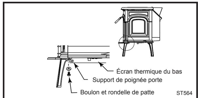
Fig. 21 Positions du porte-poignée et de l'écran thermique.
