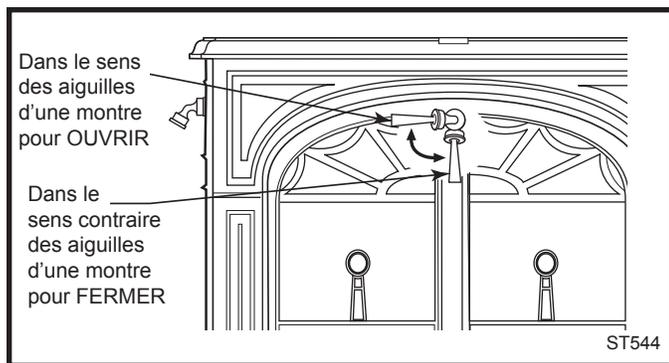
**Fig. 34** Pour ouvrir les portes avant, tournez la poignée dans le sens des aiguilles d'une montre.
