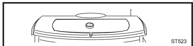
**Fig. 35** Mesurez la température avec un thermomètre situé au milieu de la plaque chauffante.
