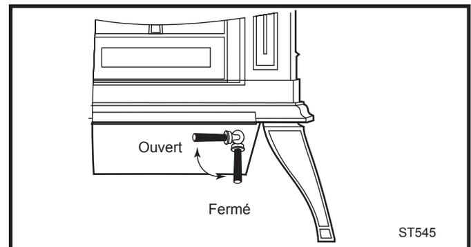
**Fig. 39** Tournez la poignée du cendrier dans le sens des aiguilles d'une montre pour l'ouvrir et dans le sens contraire des aiguilles d'une montre pour le fermer.
