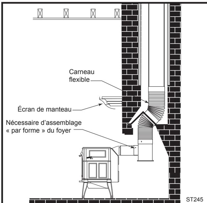
**Fig. 8** Installation par de foyer.
