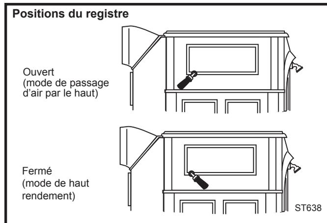
**Fig. 32** Positions de fonctionnement du registre du Encore.
