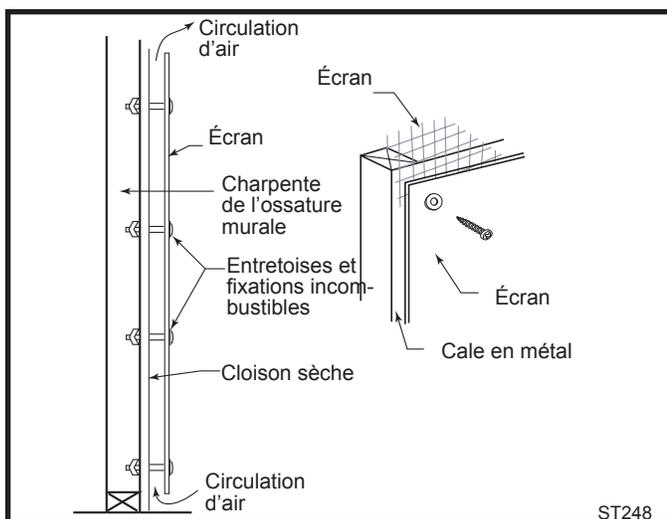
Fig. 12 Construction approuvée d'un écran mural.
