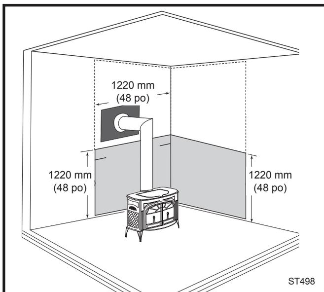
**Fig. 16** Installation parallèle avec passe-mur arrière, écrans à paroi double. Dégagements réduits pour les parois arrière et latérales. Les écrans thermiques muraux peuvent se rencontrer dans un coin, si désiré. Le passe-mur doit être conforme aux codes.
