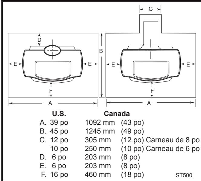
Fig. 11 Dimensions requises pour la protection de sol.
