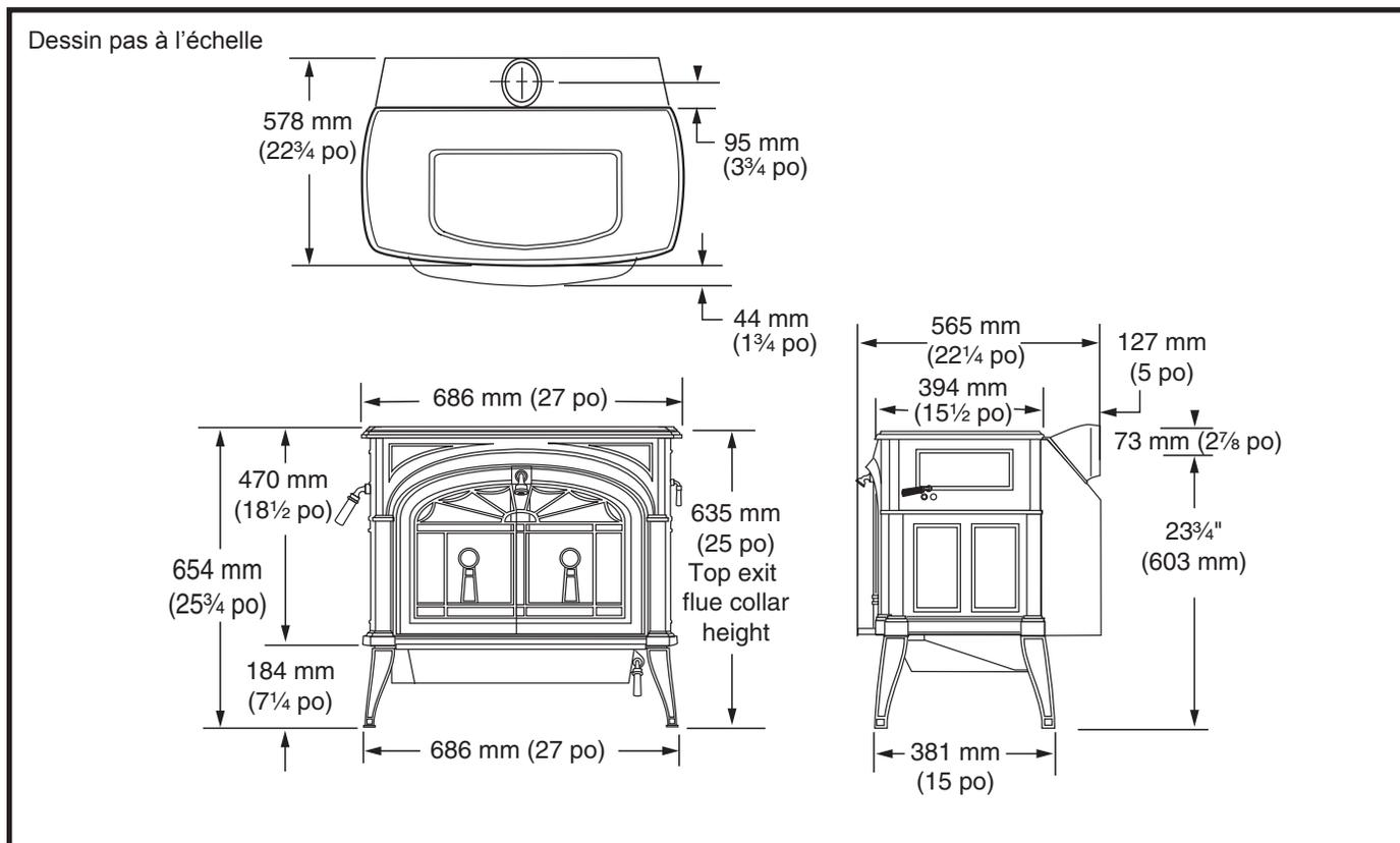
Fig. 1 Dimensions du modèle Encore.
