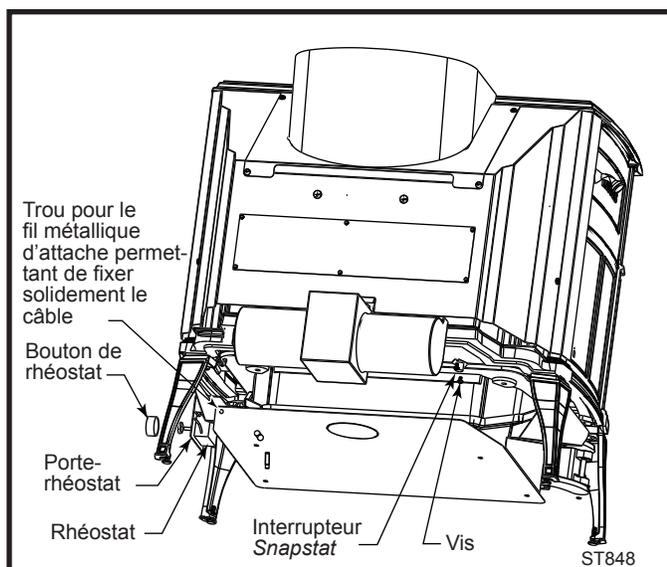
Fig. 26 Installation du ventilateur (nécessaire n° 2767).
