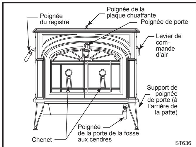
**Fig. 30** Les commandes du Encore sont placées à portée de main et faciles à utiliser.
